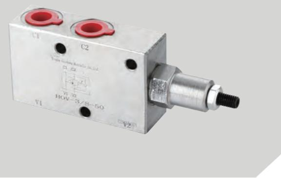
当V2口的压力升高到单向阀调定的压力时,阀芯被推离阀座,油液可以从V2到C2自由流动,当作用在C2口的负载压力足够大时,作用在阀芯环形面积差上的力大于弹簧设定的力时,油液可以从C2口流向V2口,阀起溢流作用。根据阀所具有的先导压力比,V1-C1的先导压力与弹簧的设定压力相比被比例的减小直到阀芯打开,油液可以C2口到V2口自由流动,弹簧腔与V2口相通,V2口的背压要附加到弹簧设定压力上。
